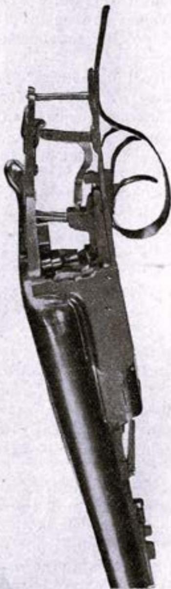
Fig. 34. — Meccanismo del fucile senza cani esterni, sistema Zanotti, visto di fianco a triplice chiusura, doppia stanghetta e sicura indipendente.
